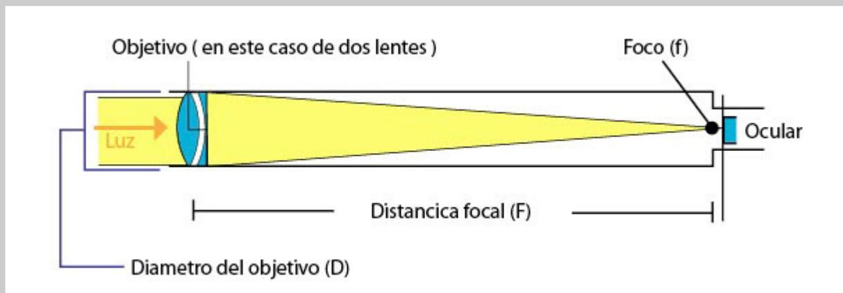
Aumentos: los aumentos en un telescopio son provistos por los oculares, los cuales se ubican en el plano focal del instrumento. Los oculares son intercambiables y el aumento logrado con cierto ocular dependerá de la distancia focal del ocular y de la distancia focal del telescopio. Para calcularlo debe dividirse la focal del telescopio por la focal del ocular. Por ejemplo: un telescopio de 1000 mm de distancia focal en donde se utilice un ocular de 25 mm de focal, brindará 40 aumentos (40x).
